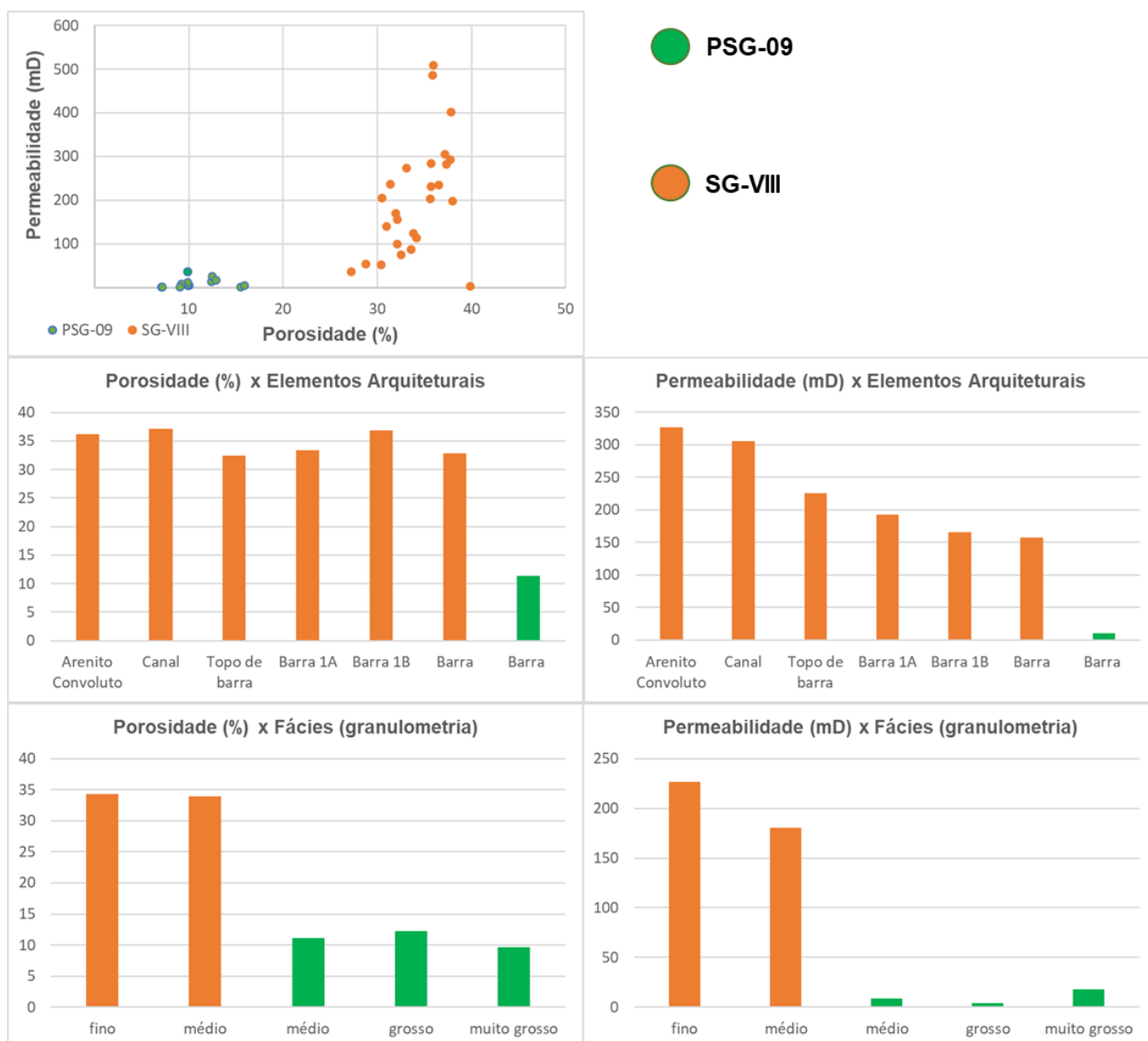
Figura 32. Gráficos de porosidade e permeabilidade em relação aos afloramentos, elementos arquiteturais e fácies.
