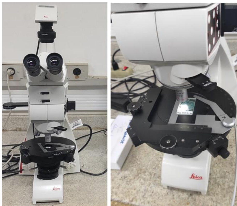
Figura 18. À esquerda microscópio petrográfico Leica DM750P, à direita charriot em detalhe
